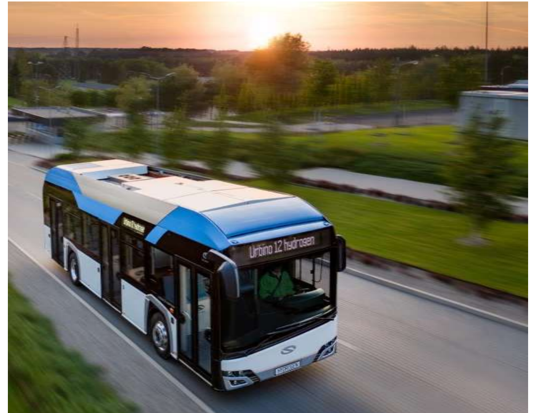
Foto: Autobus na vodíkový pohon Solaris Urbino 12 Hygrogen (zdroj: Solaris Bus & Coach sp. z o.o. )
